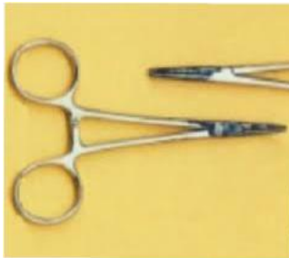
Resim 3. 2: Metal araç gereçlerin korozyonu
